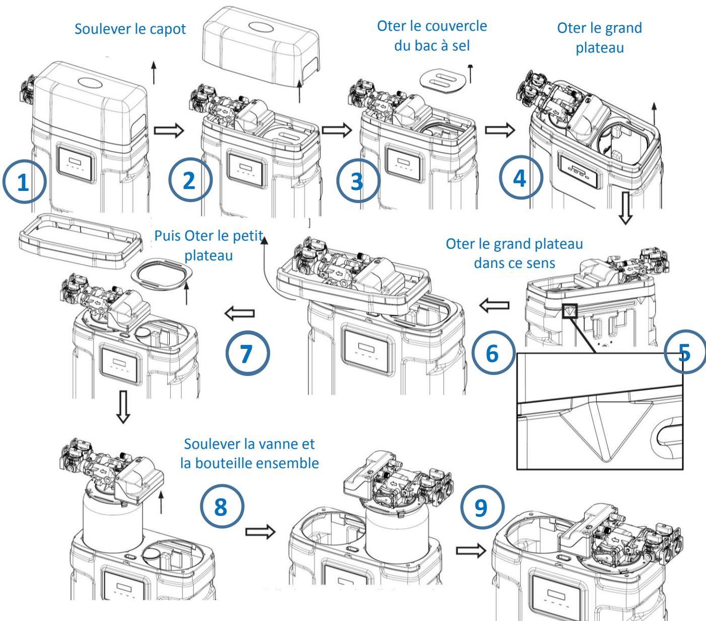
Veiller à déconnecter le cordon d'alimentation électrique et le tuyau d'écoulement de la saumure au préalable
